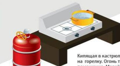
Кипящая в кастрюле вода попадает на горелку. Огонь тухнет. Газ заполняет помещение. Малейшая искра (зажженная спичка, нажатие клавишей выключателей и т.д.) приводит к взрыву
