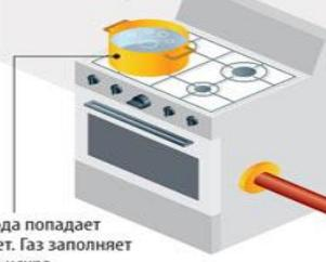
От долгой или неправильной эксплуатации происходит разрыв шланга, соединяющего газовую магистраль с плитой. Газ постепенно заполняет помещение. Искра – взрыв
