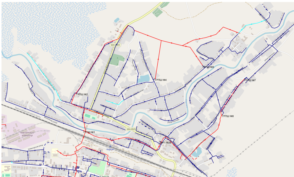
Рисунок 4 – Схемы сетей газоснабжения на севере города
