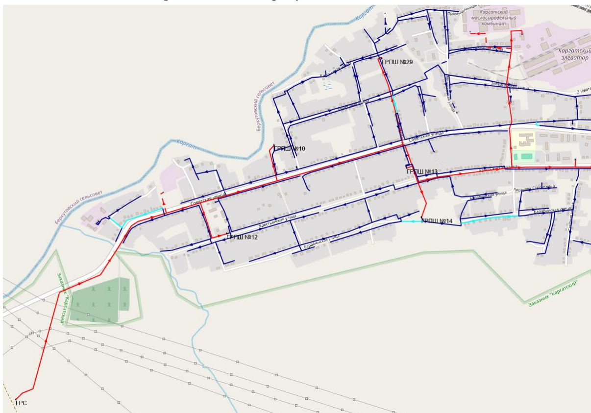
Рисунок 1 – Схемы сетей газоснабжения на западе города
